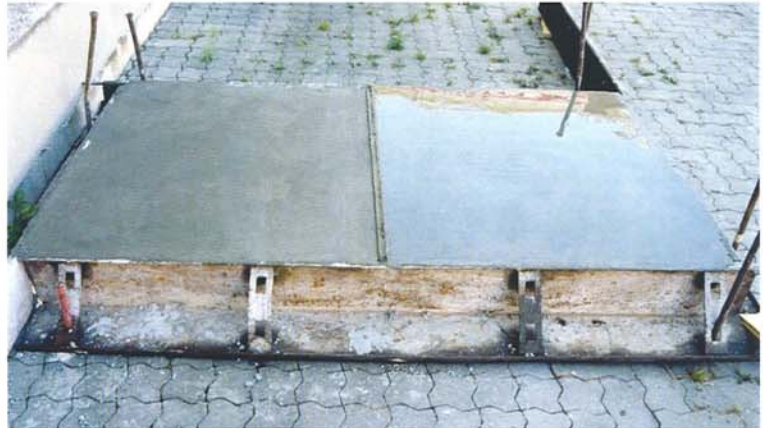
Şekil 1: deneme beton döşeme; soldaki AF uygulanmamış olan beton döşeme; sağda ise AF uygulanmış beton döşeme gösterilmektedir.
